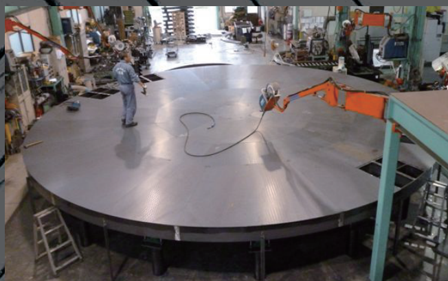
大型トラック方向転換用ターンテーブル Φ9000・20000kg仕様
