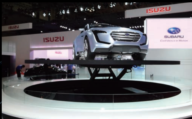
設置場所：モーターショー リフター付ターンテーブル・Φ4500・25000kg
