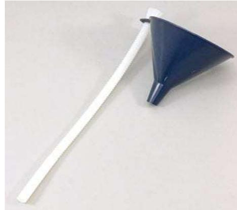
駆動ローラの穴より減速機オイル注入口へロート(じょうご)を差し込む
