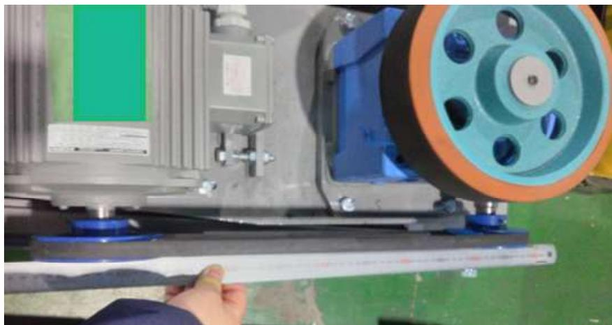
減速機を交換後、駆動装置単体で動作確認する。
