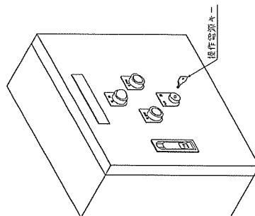
操作電源キーを差し込み、“手元”にします。
