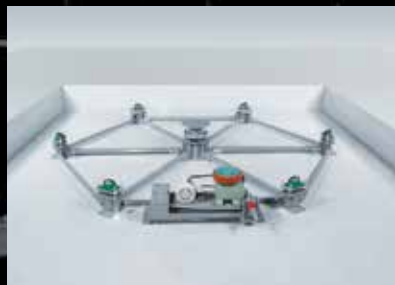
②下部ベース組立 下部ベースを配置し外周SW車輪・ 中心軸のレベル調整。
